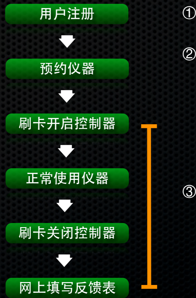
电源控制的仪器使用流程图
