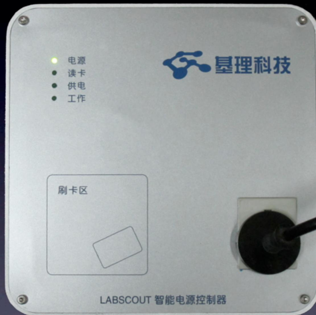
第二步：在控制器**刷卡区**使用一卡通刷开控制器，成功刷开后**供电**灯亮起
